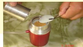
५. आवश्यकतानुसार १०० मि.लि.(प्रशोधित पानी भएमा) अथवा ५० वा १० मि.लि. (अप्रशोधित पानी भएमा) फिल्टर कपमा राख्नी पम्पले तानेर फिल्टर गर्ने । १००, ५० र १० मि.लि. को चिन्ह फिल्टर कपमा कोरिएको हुन्छ ।
