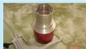
४. चिम्टालाई लाइटरले निर्मालिकरण गर्ने र मेम्ब्रेन फिल्टरलाई चिम्टाको सहायताले निकाली एक हातमा लिई अर्को हातले फिल्टर कपलाई उठाई फिल्टर पेपर राखेर राम्रोसंग कस्ने ।
